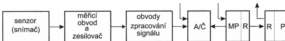
Obr. 1.1 Blokové schéma měřicího řetězce se senzorem A/Č – analogově číslicový převodník včetně vzorkovacích zesilovačů, multiplexerů apod., MP – mikropočítač (resp. mikrořadič, signálový procesor apod.), R – rozhraní, P – nadřazený výpočetní systém
